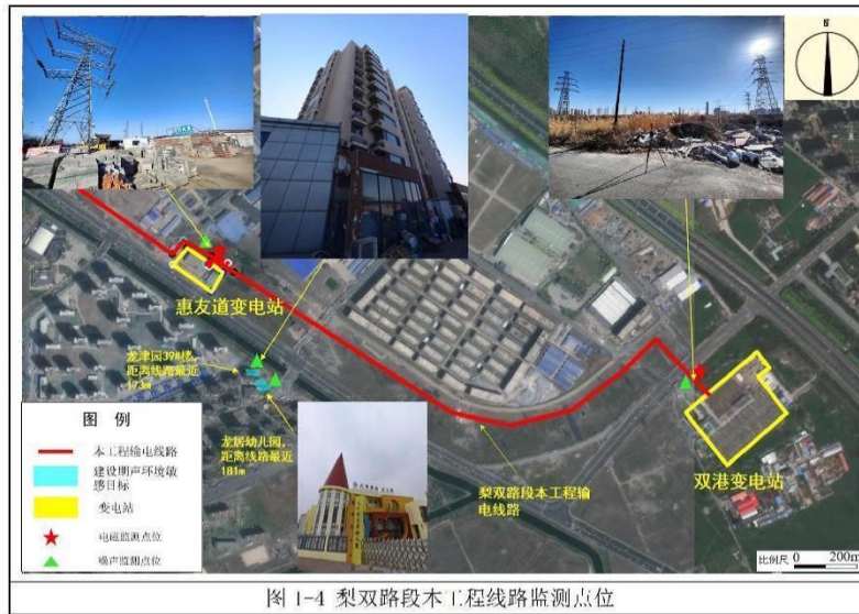
图 1 电磁环境及噪声监测点位示意图
